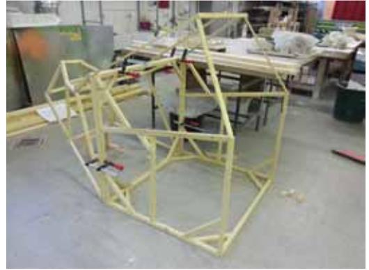
L'hélicoptère est composé de 11 modules s'emboîtant les uns dans les autres. La structure porteuse est réalisée en tasseaux de sapin. Chaque module a des dimensions inférieures à celle d'une double porte afin qu'il puisse sortir des ateliers mais aussi et surtout être remonté dans la salle d'exposition.
